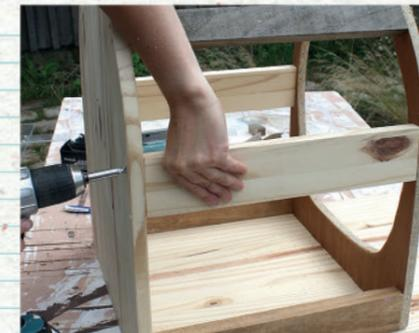
**2** Découper à la scie sauteuse les éléments et les assembler. Visser 6 tasseaux de 34 cm de haut (prévoir env. 1 cm de plus que la hauteur du seau) et d'au moins 2 à 3 cm d'épaisseur. Prendre de l'OSB ou du contreplaqué (bois recomposé pour sa solidité dans les faibles largeurs) pour faire la planche de l'assise et celle qui supportera la bavette et la lunette.
